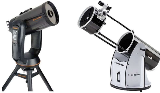
17- Duas montagens altazimutais. Em ambas, o movimento do telescópio se dá num eixo horizontal (de azimute) e num eixo vertical (de altura). O telescópio da esquerda é acionado por motores elétricos controlados por computador e o da direita é totalmente manual (crédito: Celestron).
