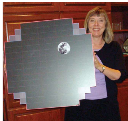
23- Modelo do mosaico de 189 CCDs que equipará a câmera de 3.200 mega-pixels do LSST, cujo plano focal terá 64 cm de lado. A imagem da Lua mostra qual será a escala do plano focal do telescópio (crédito: LSST Corporation).
